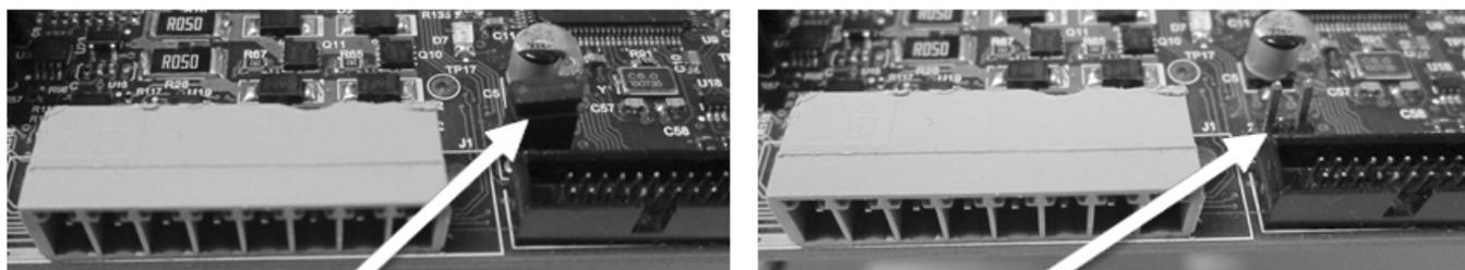
**Figure 5-7.** Jumper Cap pour Hystérésis et double sonde de sélection du mode de défaut
